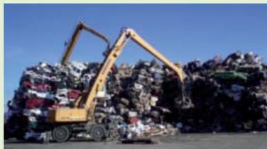
Consiste en una máquina propulsada sobre ruedas, cadenas o apoyos con una estructura superior capaz de efectuar una rotación de 360 grados que excava, carga, eleva, gira y descarga materiales por la acción de una cuchara o un pulpo fijados a un conjunto de pluma y balancín o brazo.
