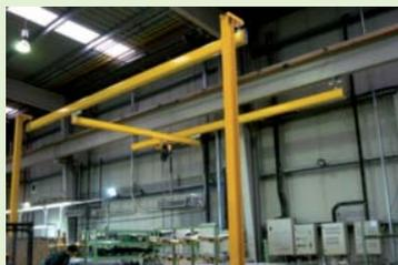
Máquina que se utiliza para la elevación y transporte de materiales en el ámbito de su acción, generalmente en procesos de almacenamiento o en curso de fabricación. Puede disponer de gancho o de pulpo. El manejo de la máquina se puede realizar desde una cabina añadida al puente-grúa, o por medio de mando a distancia con cable activado desde las proximidades del punto de operación.
