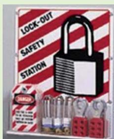
La consignación de la maquinaria consiste en un mecanismo o aparato que permite el uso de llaves o combinaciones de cierre, normalmente candados, que lo que hacen es retener la palanca de un interruptor o válvula en la posición 0: sin tensión y fuera de servicio.
